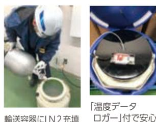
輸送容器にLN2充填 「温度データロガー」付で安心
