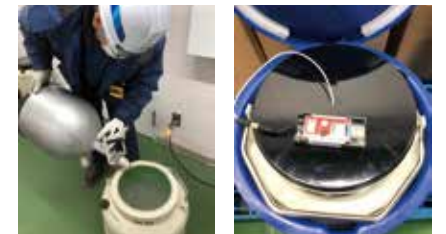
LN2 充填作業 安心の温度監視ロガー
